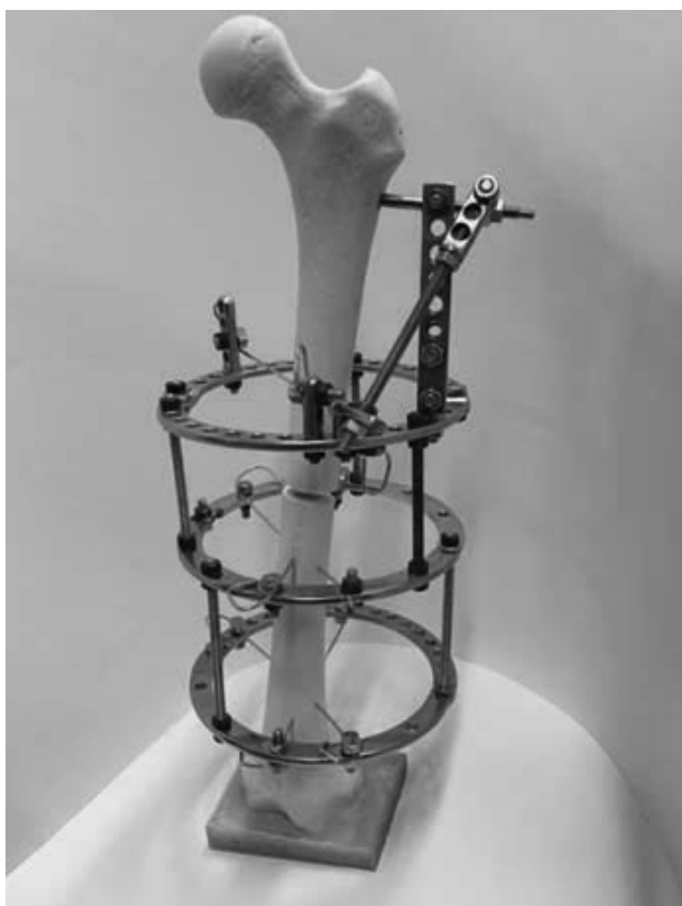
Рис. 1. Об'єкт дослідження – синтетична кістка з КФ спице-стрижневого типу
